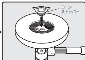
ヘッドにスポンジコーンを当て、コーンストッパーで固定します。(固定の際、ハト目の穴の位置に注意してください。)
