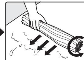
水が溜まってきたら、吸水面を回転させて違う面に変えます。
