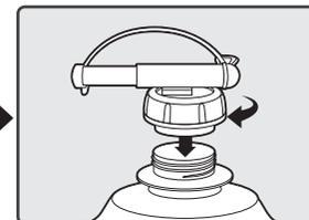
キャップを外し、コック付きキャップを取り付ける。
